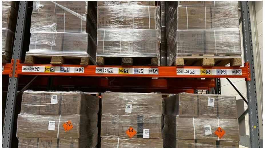
■ Die Folienetiketten sind im Vergleich zu den vorher genutzten Papieretiketten widerstandsfähiger gegenüber Abrieb, Staub und mechanischer Beanspruchung
