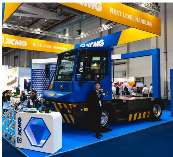
■ XCMG greift im Hafensegment umfänglich an. Neben dem E-Vollcontainer-Reachstacker folgt nun die E-Zugmaschine XPT75E mit 289 kWh Akkupack. Das maximale Zuggesamtgewicht beträgt 75 t
