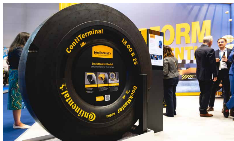
■ Der Conti DockMaster beruht auf der V.ply Technologie. Dieser massive profillose Reifen eignet sich für Greifstapler und Terminal-Fahrzeuge, die nur selten, oder mit niedriger Geschwindigkeit bewegt werden. Angeboten wird er in den Größen 18 bis 33 Zoll
