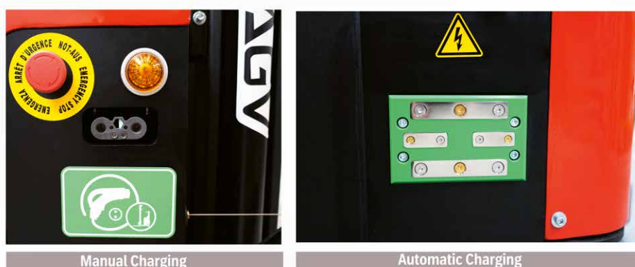
▲ Zwei Lademöglichkeiten erhöhen die Fahrzeugverfügbarkeit im Arbeitsablauf
