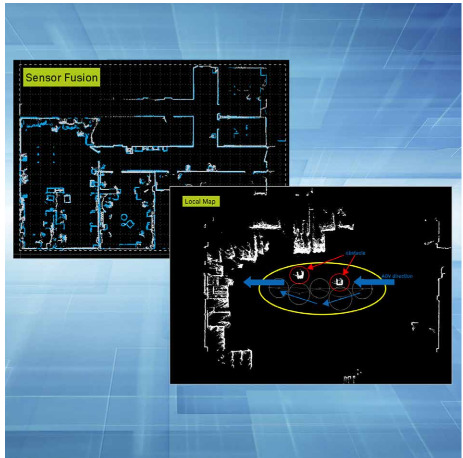
Erweiterte Funktionen in der Echtzeit-Verortungssoftware SLAMLoc sowie eine 3D-Streckenüberwachung verbessern die Navigation und Hinderniserkennung autonomer Fahrzeuge
