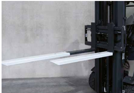
Die teleskopierbaren Gabelzinken lassen sich schnell und einfach auf die gewünschte Länge bringen
