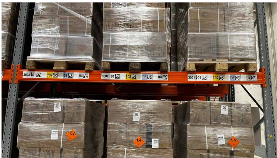
■ Die Folienetiketten sind im Vergleich zu den vorher genutzten Papieretiketten widerstandsfähiger gegenüber Abrieb, Staub und mechanischer Beanspruchung
