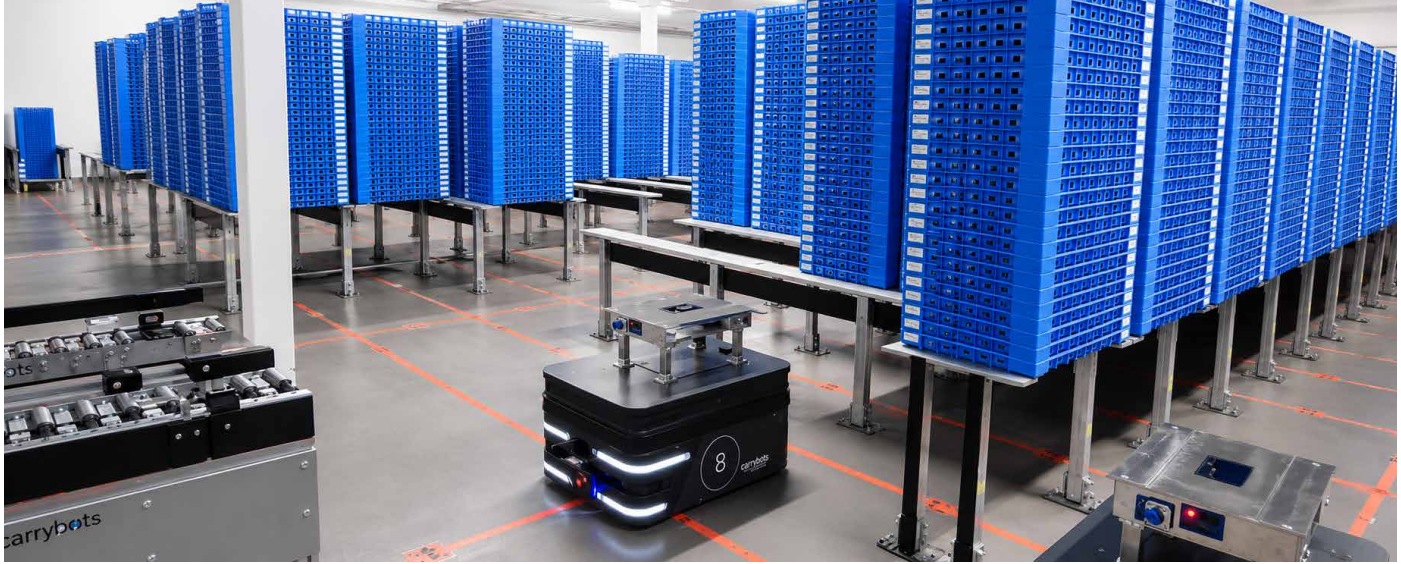
▣ Mobile Roboter sorgen im One-Level-Storage-System für einen flexiblen Produktzugriff
