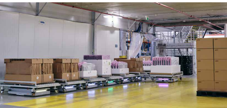
■ Die AMR bewegen Bauteile eigenständig durch die Produktion und optimieren Routen sowie Abläufe in Echtzeit
