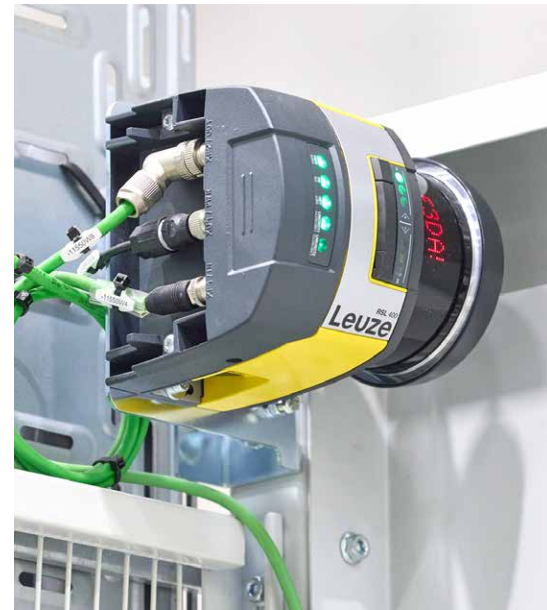
■ Sicherheits-Laserscanner RSL 400 von Leuze sichern den Zugang an den Materialübergabestationen zuverlässig ab. Sie erzeugen ein vertikales Schutzfeld und geben nach erfolgreicher Anmeldung des mobilen Roboters einen Bereich frei
