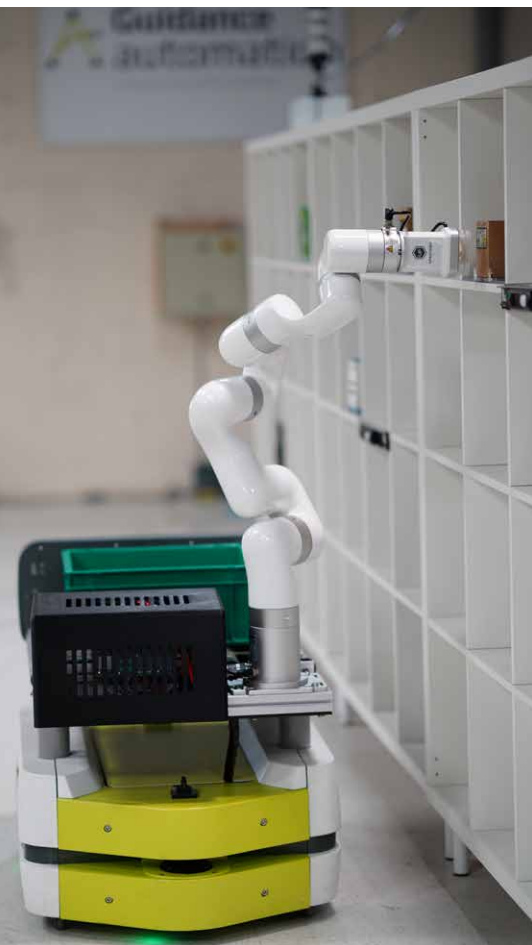
■ Der ‚Robot Worker‘ kann dahinfahren, wo die Arbeit ist und mithilfe des installierten Roboterarms flexibel reagieren
