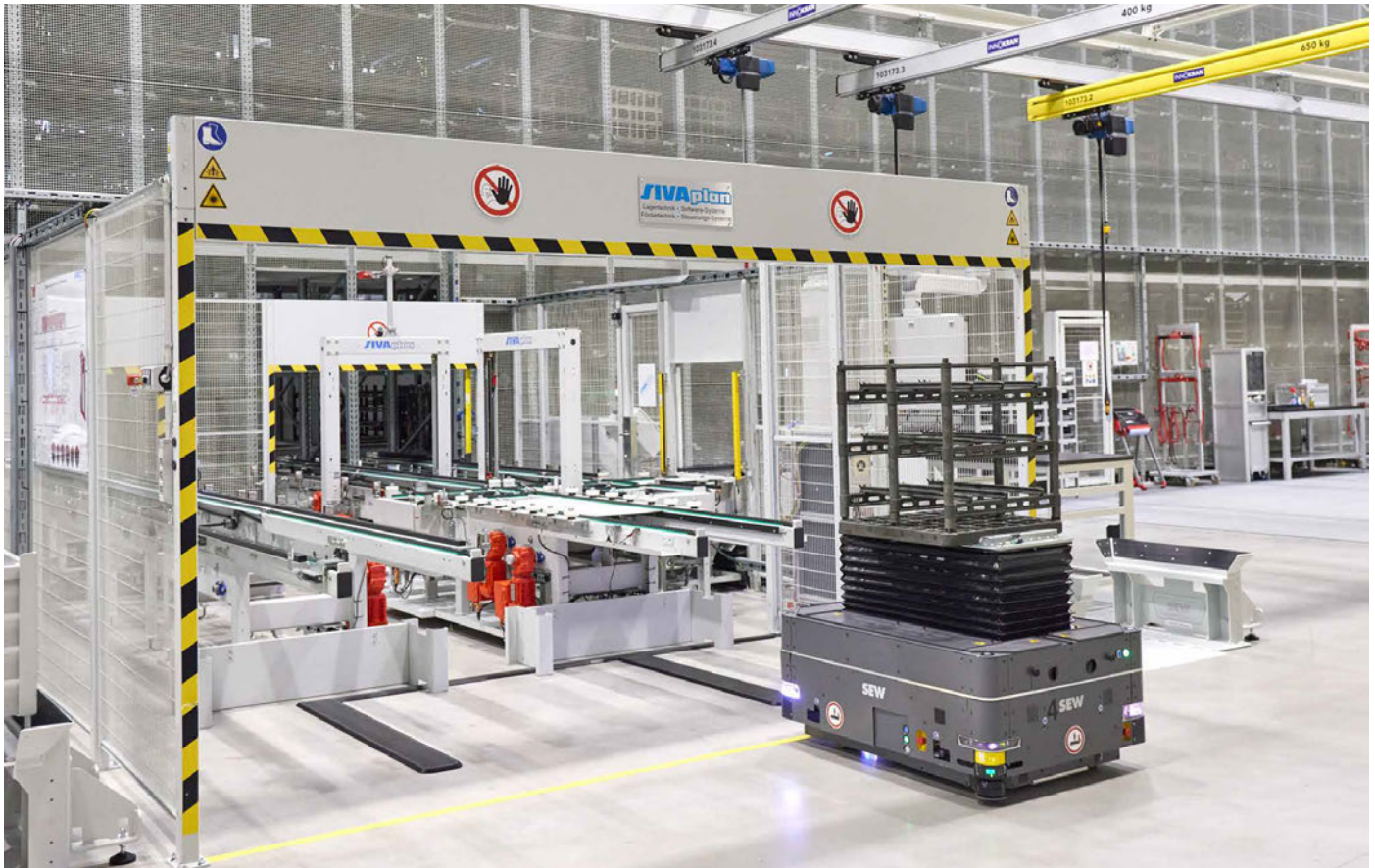
■ An vier Materialübergabestationen liefern mobile Roboter die produzierten Zahnräder und Wellen aus der Fertigung an
