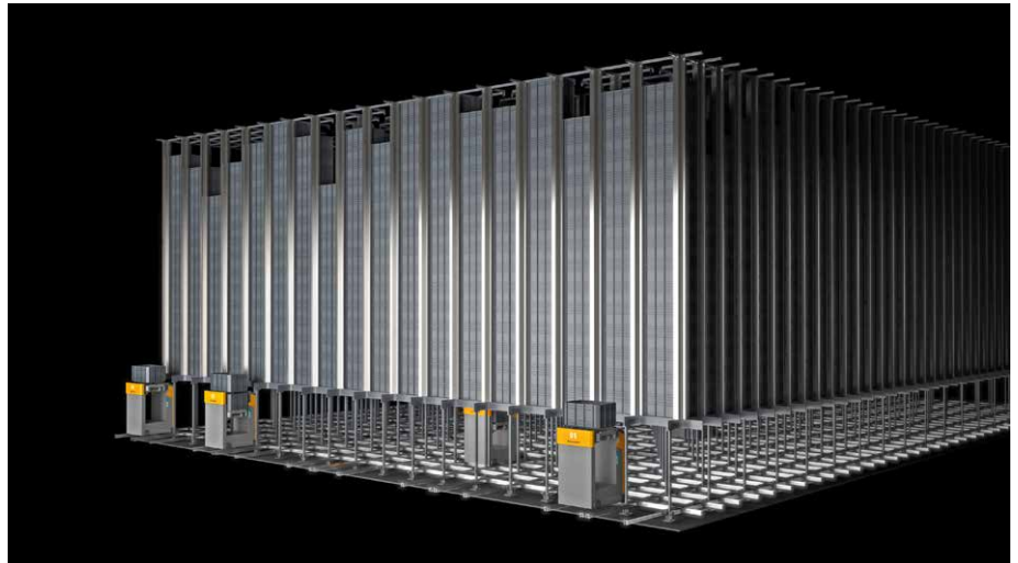
Der PowerCube stellt auf rund 210 Quadratmetern Grundfläche mehr als 6.500 Behälterstellplätze auf 26 Ebenen bereit
