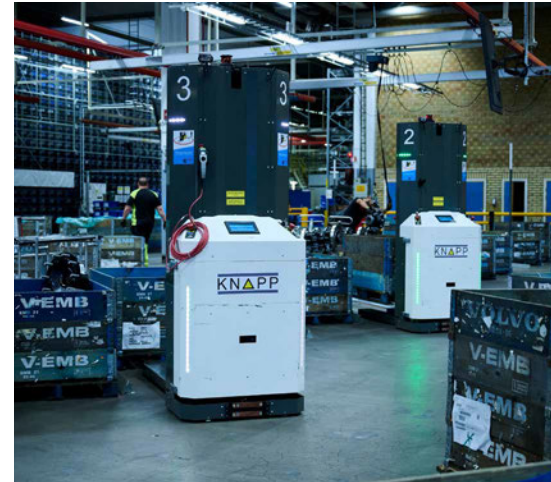
▲ Die Open Shuttle Fork versorgen in der Kommissionierung 190 Pick-Stationen just-in-time mit den benötigten Teilen und sorgen so für eine effiziente Produktionslogistik
