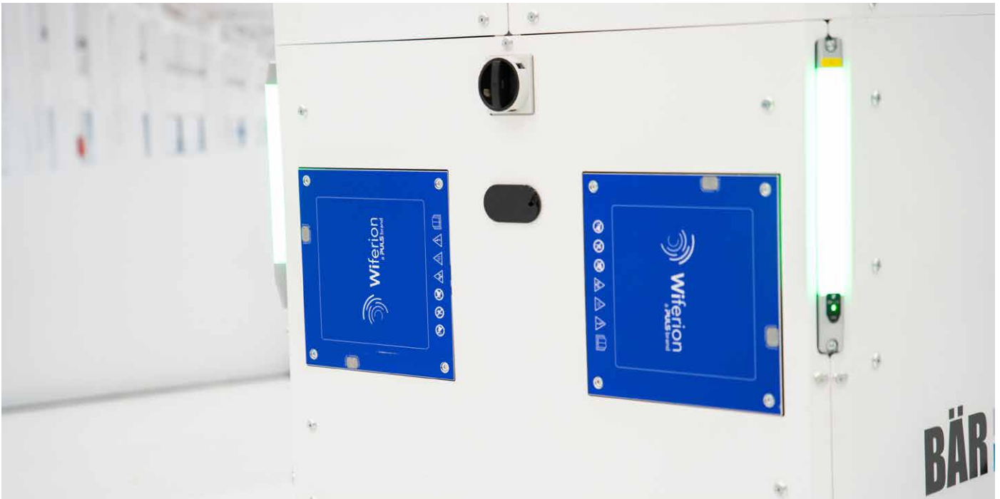
■ Die induktiven Ladepads von Wiferion übertragen die Energie durch ein geschlossenes Gehäuse, freiliegende Kontakte oder anliegende Spannung gibt es nicht
