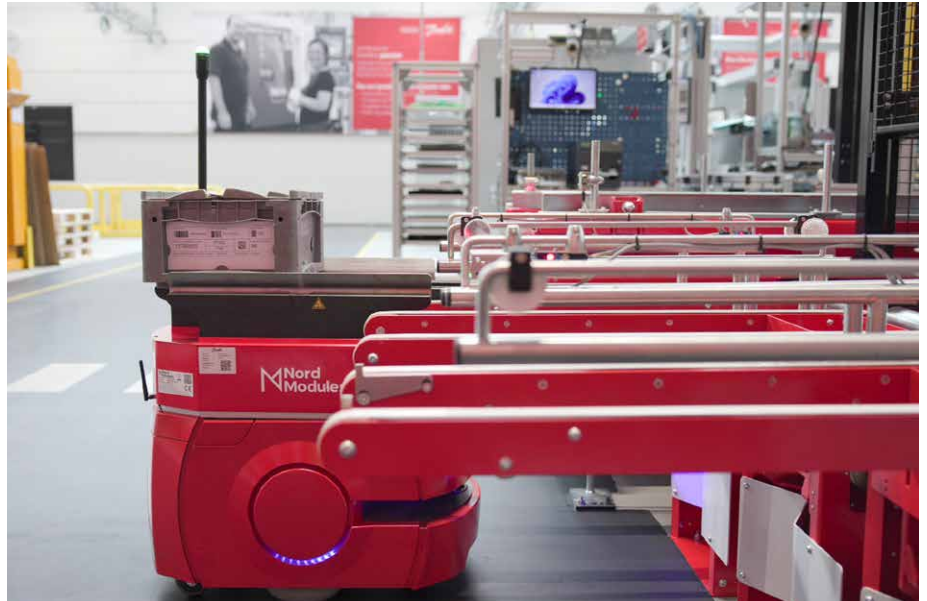
Die mobilen Roboter „Egon“ und „Yvonne“ transportieren Artikel zum AutoStore-System und zurück
