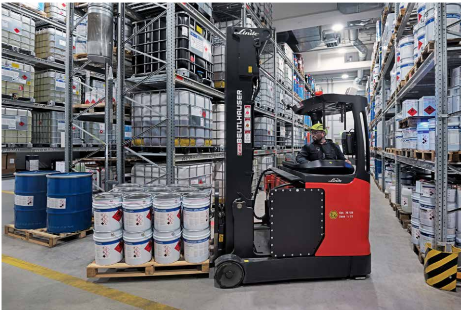
■ Ab Werk explosionsgeschützte Schubmaststapler vom Typ Linde R14 EX bedienen das Breitgangregal
