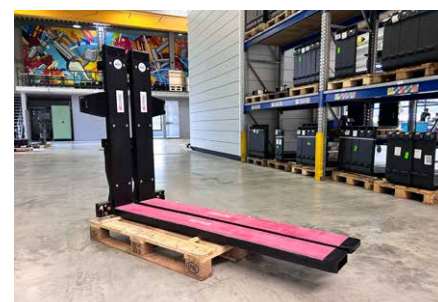
▣ AGV-Gabelzinken mit Sensorik in der Gabelspitze und im Gabelrücken, speziellem „Swanneck“ Gabelknick und Gabelzinkenbeschichtung auf dem Gabelblatt
