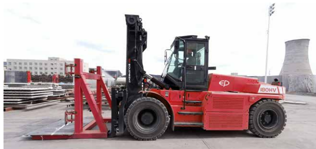
■ Der EP EFL1803-HV mit 18 t Tragkraft
