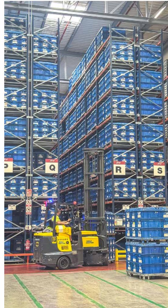
▲ Die Wendigkeit und die Hubhöhe von 10 m unterstützen die verbesserte Nutzung der Lagerkapazitäten
