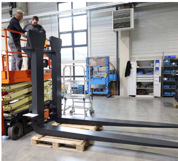
▣ Großgabelzinken für den Schwerlastbereich von bis zu über 120 t
