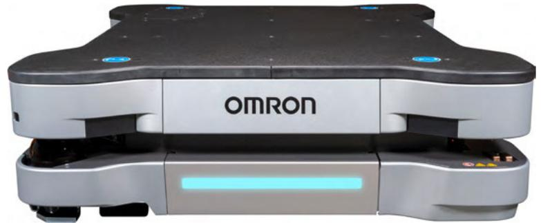
Steuerung aller FTS durch proprietäre Software und ein hohes Sicherheitsniveau gemäß internationaler Norm ISO3691-4. Mit der Fleet Manager Software ist die integrierte Steuerung von bis zu 100 mobilen Robotern über ein einziges System möglich.
