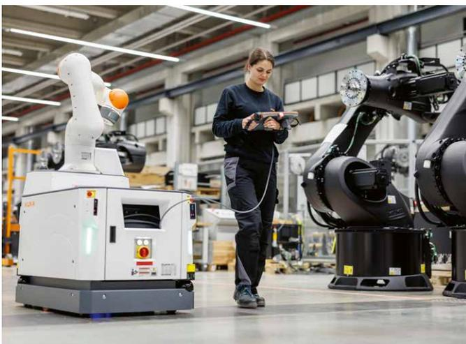
▣ Sowohl Cobot als auch Plattform werden über dasselbe smartPAD pro gesteuert - ein zweites Bediengerät ist nicht notwendig.
