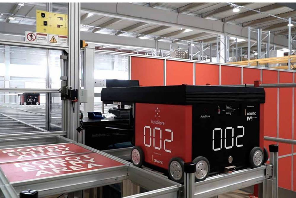
▲ Dematic installiert kompaktes AutoStore-System mit sieben R5 Robotern und 5.005 Behältern auf nur 190 Quadratmetern.
