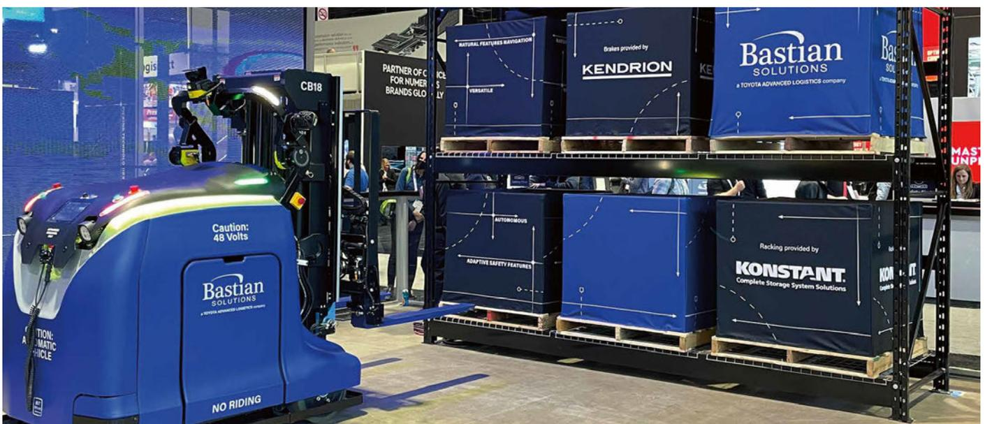
▲ Die FTS des US-Herstellers Bastian Solution wurden mit kundenspezifischen Federkraftbremsen ausgerüstet, die sich unter anderem durch ein fein abgestimmtes Bremsmoment in einem engen Toleranzband auszeichnen.
