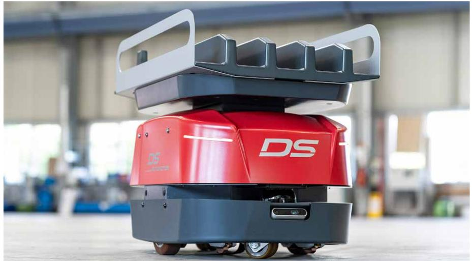
▶ Amy ist der jüngste und kleinste Neuzugang der AMR-Flotte und für den fahrerlosen Transport kleiner Lasten bis 25 kg ausgelegt.
