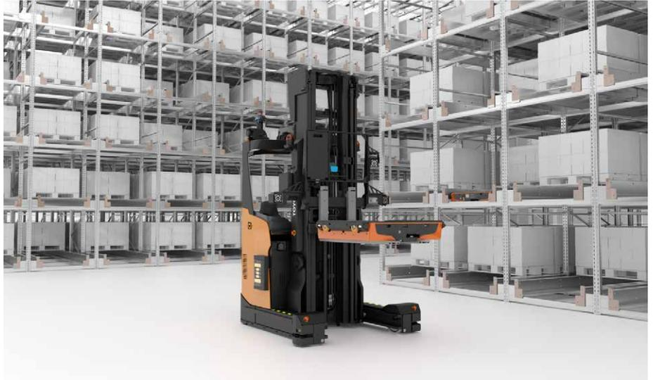
Der automatisierte Schubmaststapler BT Reflex RAE Autopilot speist die Waren in das automatische Lager- und Abrufsystem „Swarm Automation Storage“ ein.
