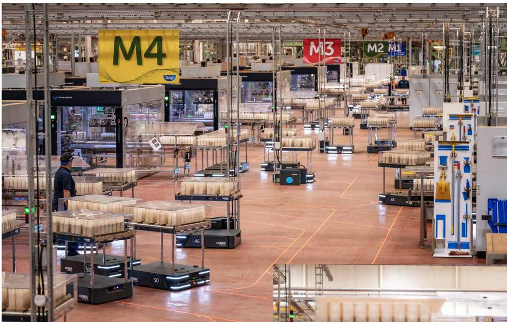
77 Fahrzeuge bewegen in acht Kreisläufen 912 Teeträger pro Minute. Das entspricht einer Tagesleistung von knapp 100 Tonnen Tee und einer Fahrstrecke von ca. 750 Kilometern.
