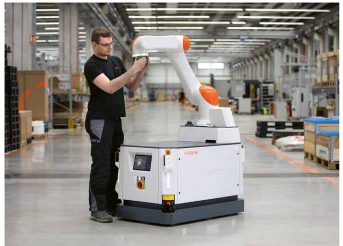
▣ Sollten Wartungsarbeiten anfallen, können diese mithilfe großer Zugangsluken am KMR iisy sowie der einfach austauschbaren Steuerungs- und Schaltelektronik der KMP 1500P problemlos und schnell vorgenommen werden.
