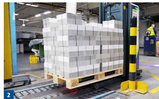
2 Der autonome Palettentransporter Wewo AGV Palletmover liefert direkt in die Verpackungsanlagen ein.
