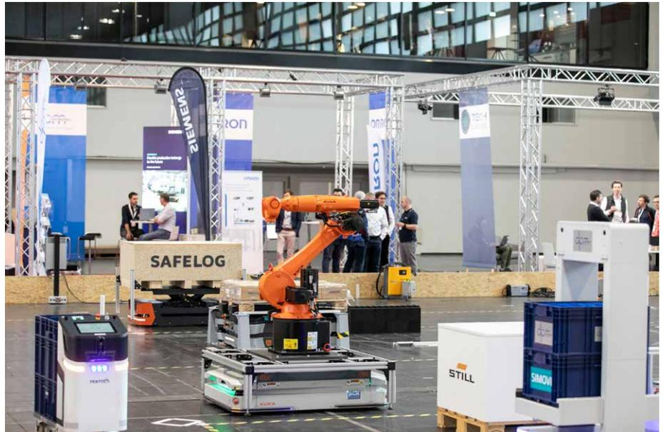
▶ Beim AGV Mesh-Up haben im April 2024 insgesamt zehn Unternehmen die Funktionsweise der VDA 5050 mit einer gemischten Flotte von mobilen Robotern gezeigt.
