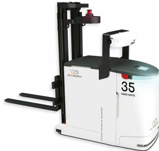
■ Zusätzlich zu den freitragenden Gabeln werden die sechs Fahrerlosen Transportfahrzeuge mit Geräteklammern ausgerüstet.
