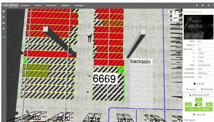
▣ Mithilfe von Industriekameras und der NVIDIA Orin-Technologie werden Positionsdaten ermittelt. Dabei kann eine Kamera Flächen von bis zu 1.500 m<sup>2</sup> überwachen.
