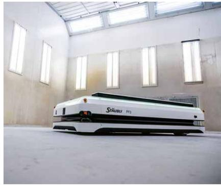
nehmen. Muss der Anwender zum Beispiel nur eine Tonne manövrieren, reduzieren wir das Gegengewicht im Roboter entsprechend. Überflüssige Masse würde nur die Batterie unnötig belasten.
