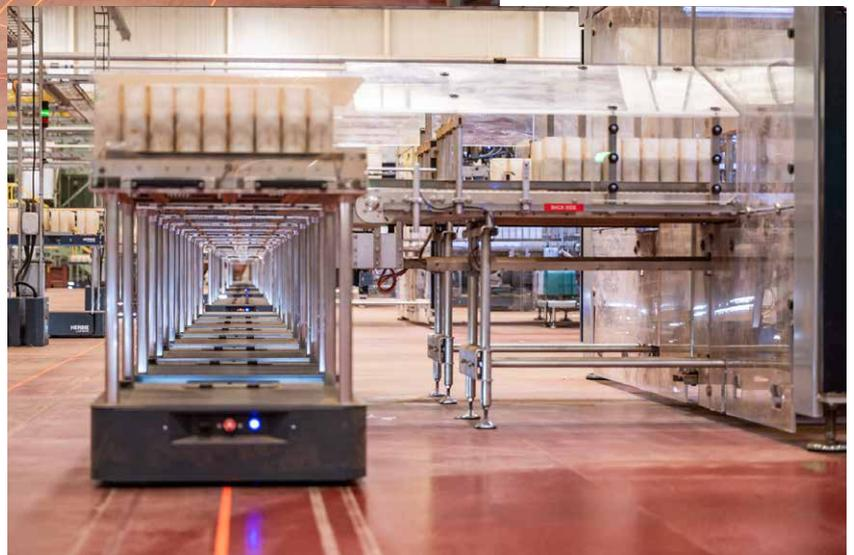
Herbie wurde nahtlos zwischen hoch getakteten Primärverpackungsmaschinen und Sekundärverpackungsmaschinen (Kartonierern) integriert.
