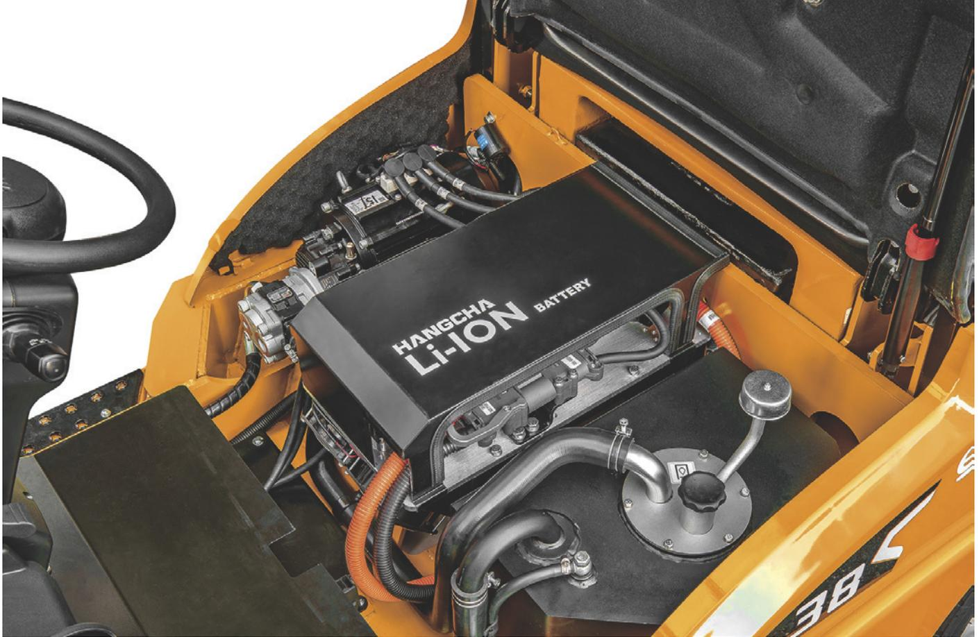
▲ Blick auf die Hydraulikeinheit und die Abdeckung der Steuerungen. Die Li-Ion Batterie, die bis zu 80V/603Ah betragen kann, ist wie bei der XC-Serie, geschützt, in einem tiefliegenden Fach verbaut.
