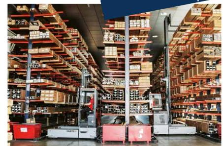
Des Weiteren im Fokus: die Flagship-Baureihe Phoenix. Diese, verfügbar in Tragfähigkeitsklassen bis zu 35 Tonnen, wird häufig für schmale Gänge in Langgutlagern konfiguriert. Genau dafür wurde die neue Gangeinfahrhilfe entwickelt, ein Assistenzsystem, das dem Fahrer eine halbautomatisierte Einfahrt des Mehrwege-Seitenstaplers in den Schmalgang ermöglicht. Das patentierte System reduziert das Risiko von Beschädigungen und trägt damit erheblich zur Senkung von Reparaturkosten bei.
