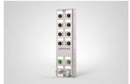
Access-Serie umfasst leistungsstarke IO-Link Master und Hubs, die sich komfortabel über Webinterfaces konfigurieren lassen.
