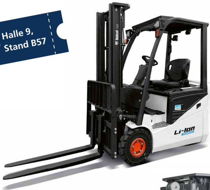
Dank der robusten 8-mm-Metallschürze, des stabilen Fahrgestells, des langlebigen Masts und der Batterieabdeckung aus Metall – zusammen mit hochwertigen Komponenten von führenden Herstellern – senken diese Modelle die Wartungskosten und gewährleisten eine ständige Einsatzbereitschaft für den professionellen Gebrauch. Das EPS-System in Verbindung mit der proportionalen Hubfunktion ermöglicht reibungslose und mühelose Stapelvorgänge.
