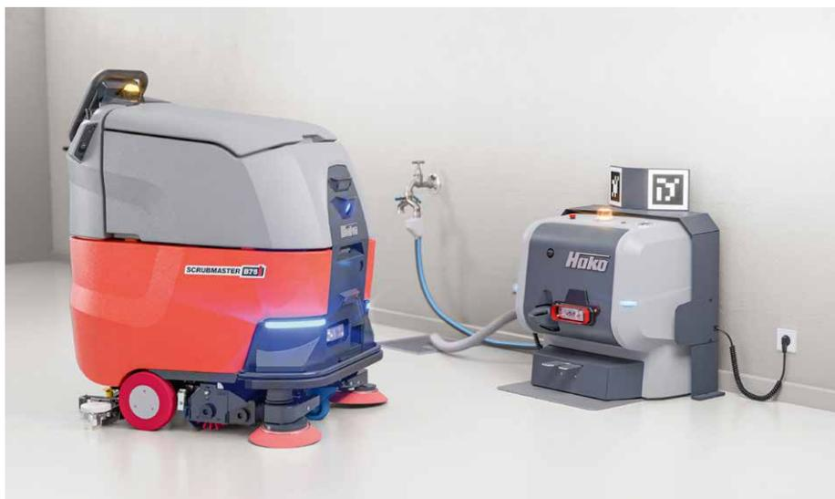
Digitalisierung und Robotik machen Reinigungsansätze effizient und transparent, indem sie wertvolle Daten für Kosten- und Ressourceneinsparungen liefern. Die autonome Scheuersaugmaschine Scrubmaster B75 i reinigt lange Gänge und große Flächen schnell und zuverlässig. Dank präziser Routennavigation senkt sie auch den Verbrauch von Wasser, Reinigungsmitteln und
