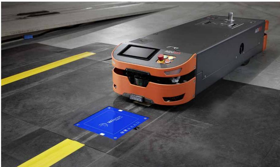
▲ Bild 2: Induktive Ladesysteme ermöglichen das berührungslose Nachladen.
