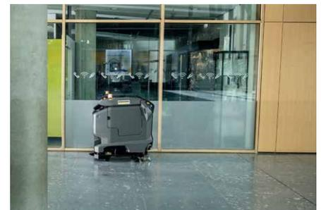
Der Reinigungsroboter ist mit leistungsstarken Sensoren und Laserscannern ausgestattet, um ein zuverlässiges Navigieren auch in Krankenhausfluren zu ermöglichen.
