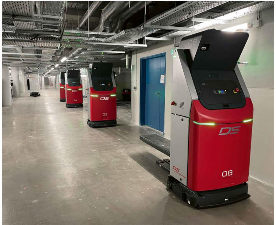
▲ LUCY transportiert Gitterboxwagen und Rollcontainer bis zu 500 kg bei einer Geschwindigkeit von 1,8 m/s. © DS Automotion GmbH
