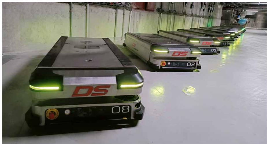
■ Für größere Transportaufgaben wurde CAREY entwickelt – ein Roboter für den Containertransport. Dank seiner Fähigkeit, unter Containern zu fahren, werden die engen Räume optimal genutzt. © DS Automotion GmbH
