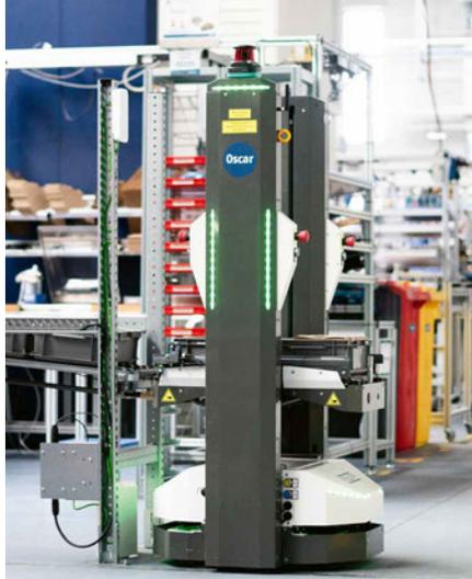
Das Open Shuttle ist in der Lage, Behälter auf Durchlaufregale (Flowracks) abzugeben. Im Fall von SCHUNK sind diese maßgeschneidert und mit einer Stellplatzsensoren zur Aufnahme und Abgabe von Behältern ausgestattet.
