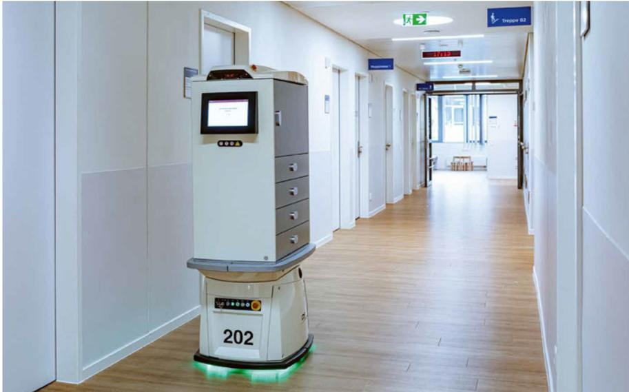
▣ Kurierroboter SALLY transportiert kleinere Lasten wie Medikamente oder sterile Instrumente. Er bewegt sich sicher durch das Krankenhaus und nutzt dabei auch Aufzüge oder schmale Gänge. © DS Automotion GmbH
