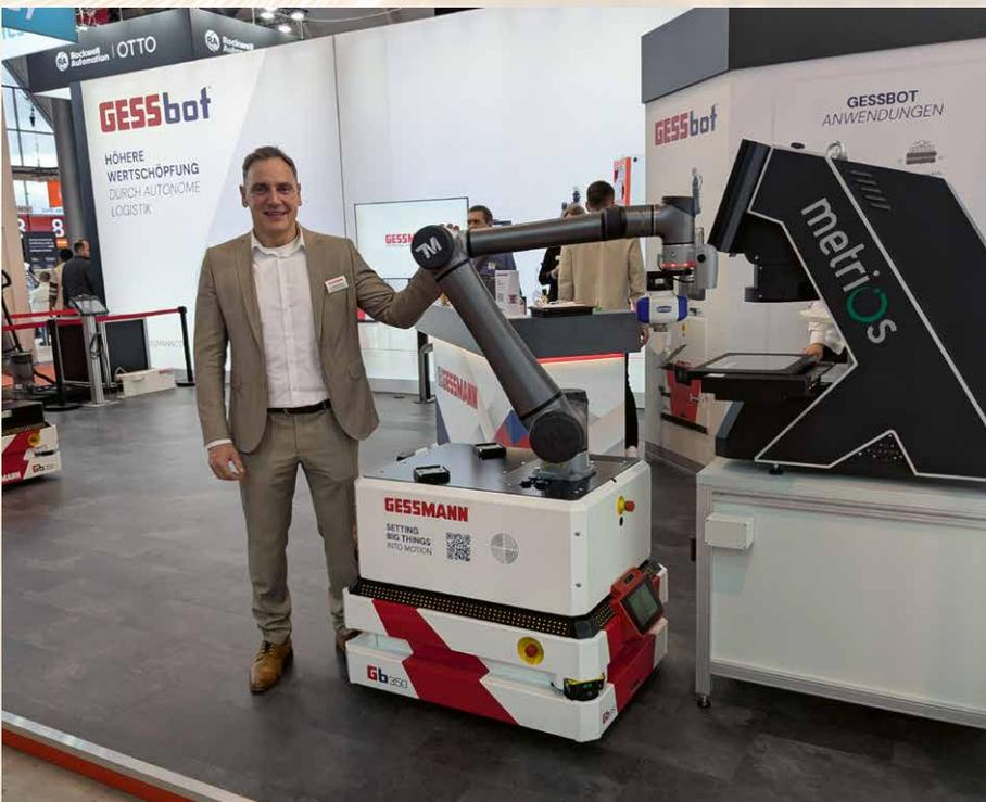
▣ Steffen Kuhnle, Director Business Unit Robotic bei Gessmann, demonstrierte den GESSbot mit TM-12 Cobot Modifikation. Dieser ist in der Lage unterschiedliche Aufgaben an verschiedenen Maschinen und Übergabepunkten zu realisieren.
