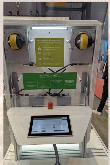
▣ Interessante Einblicke in den ArgoDrive gab es bei ebm-papst. Die Antriebstechnologie ermöglicht Fahrerlosen Transportfahrzeugen komplette, omnidirektionale Freiheit in der Beweglichkeit.
