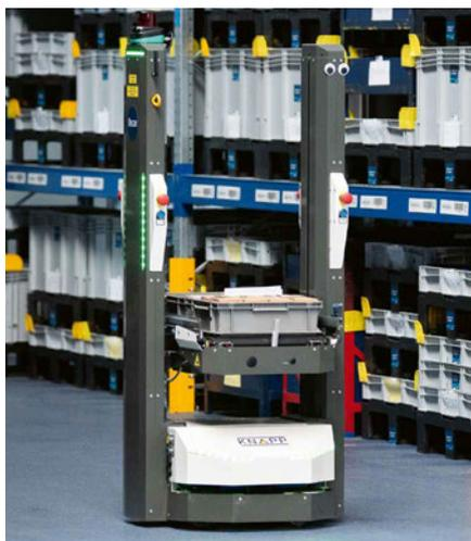
▲ Das Open Shuttle navigiert autonom durch die Lagerhallen. Dank 3D-Hinderniskamera und spezieller Sensorik ist es personensicher und kann auch in schmalen Gängen mit Personen- und Staplerverkehr eingesetzt werden.
