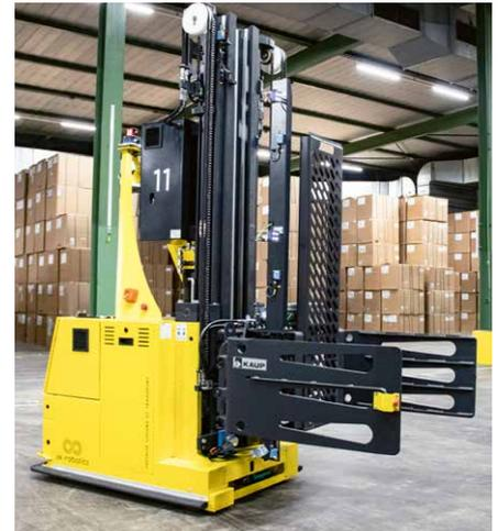
Die Ballenklammern 1T413 werden von einem namhaften Tabakwarenhersteller für das Handling von Kartons mit Rohtabak genutzt.
