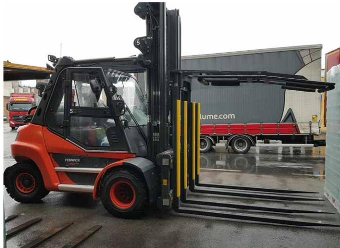
Die Mehrfachpalettengabel DKPI bei der Aufnahme von zwei mal zwei Paletten mit zusätzlichem Lasthalter.
