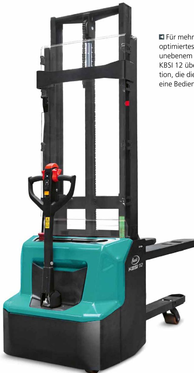
■ Für mehr Bodenfreiheit und optimiertes Handling auf leicht unebenem Gelände verfügt der KBS 12 über eine Initialhubfunktion, die die Gabelzinken über eine Bedienfunktion anhebt.
