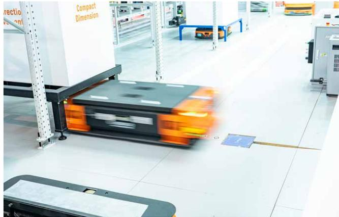
■ Hikrobot setzt auf induktives Laden als Standard für die Energieversorgung von AMR – für maximale Effizienz und Produktivität.
