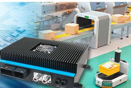
Mit dem NVIDIA AGX Orin-Modul liefert der AIB-NVAO eine Rechenleistung von 275 TOPS (INT8), was einer 8-fachen Verbesserung gegenüber seinem Vorgängermodell entspricht.
