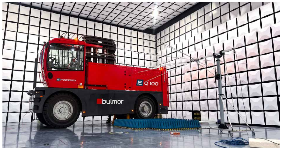
Der elektrisch angetriebene EQ100-Seitenstapler bei der EMV-Prüfung.
