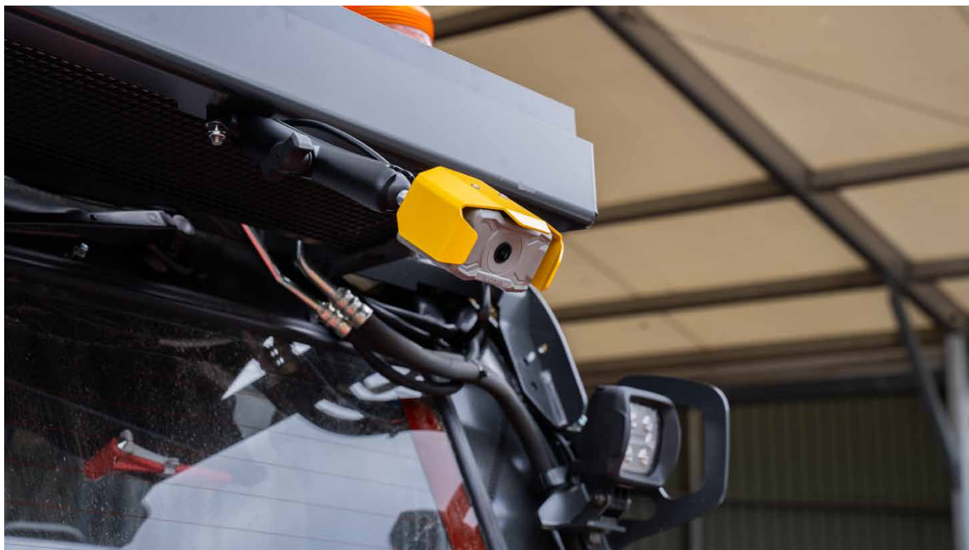
■ Das Assistenzsystem wird an der Fahrerkabine installiert.
