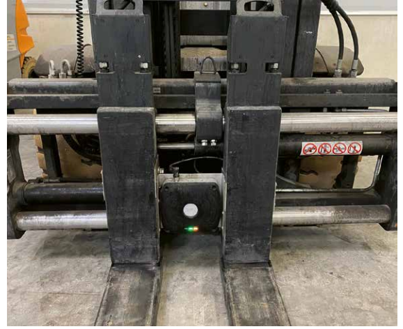
▲ Ein Weitbereichsleser je Stapler erfasst die Daten jedes Behälters direkt beim Aufnehmen.
