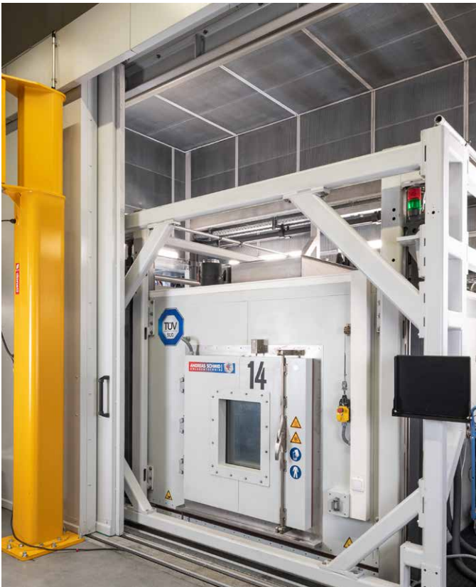
■ Ein Shaker simuliert mechanische Belastungen auf Batteriezellen und Batteriepacks.
