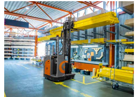
■ Der Elektro-Vierwege-Schubmaststapler ESY-S bietet doppelte Bedienelemente
