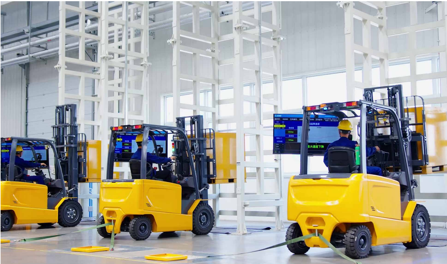
▣ Endkontrolle von XCMG-Vierrad-Elektro-Staplern auf dem Rollenprüfstand.
