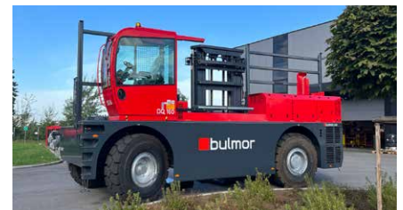
Der Heavy-Line DQ160: Diesel-Seitenstapler bis 16 t Tragkraft.
