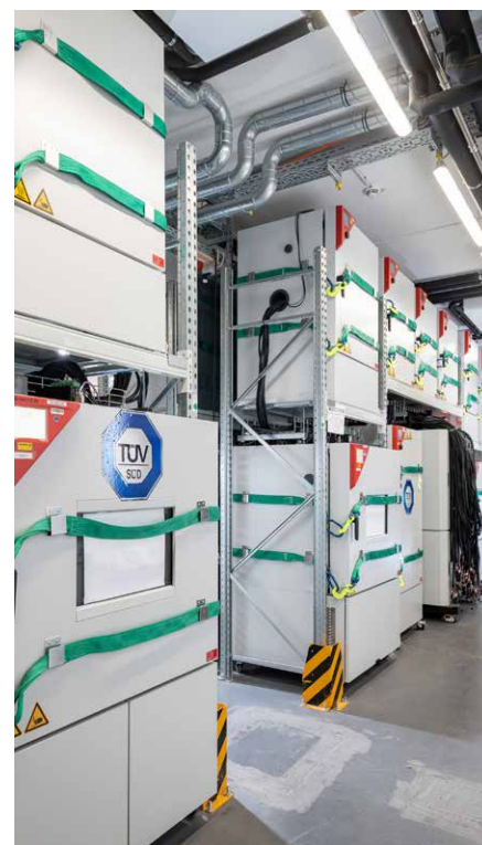
■ Zykliergeräte und Klimakammern messen Reaktionen von Batteriezellen unter Dauerbelastung.
