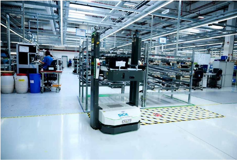
Für eine flexible und effiziente Produktionsversorgung über vier Hallen setzt SICK auf die autonomen mobilen Roboter Open Shuttles von KNAPP.
