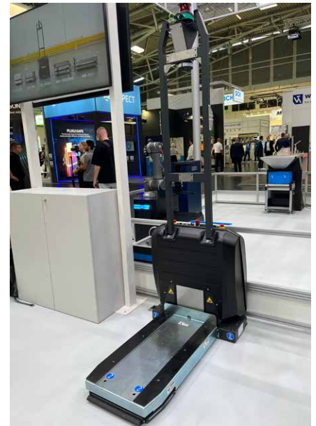
Omron präsentierte auf der automatica 2025 erstmals den neuen mobilen Roboter OL-450S. Dieser neue AMR ermöglicht mit der integrierten Hebefunktion den zuverlässigen, flexiblen Transport von Trolleys und Racks (Bild: Omron).
