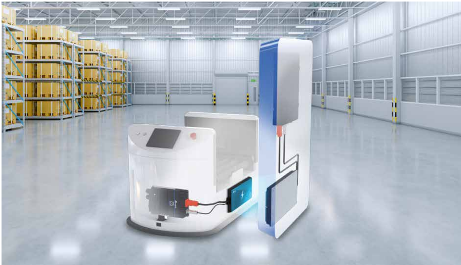
■ Das Wireless Charging System mit Pad-to-Pad-Link-Technologie ist robust gegen Staub und Schmutz.
