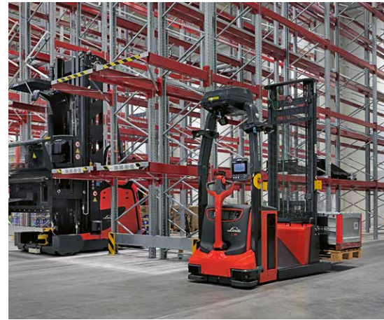
■ Das Modell K-Matic (links) gibt es in den Varianten niedriger, mittlerer und hoher Hub. Der L-Matic AC k daneben verfügt über eine Tragfähigkeit von 1,4 t
