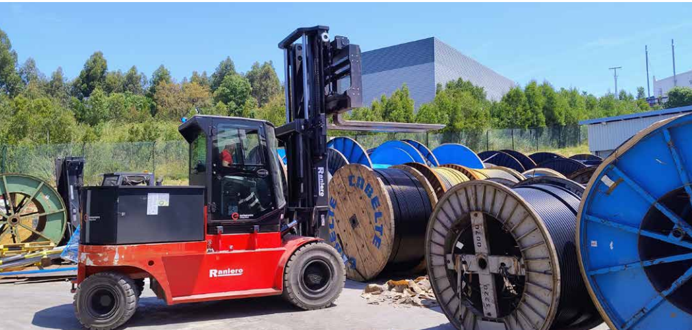
■ Frontstapler aus Italien: in der Variante AC160L-25 120 V mit Premium Kabine Magnifica
