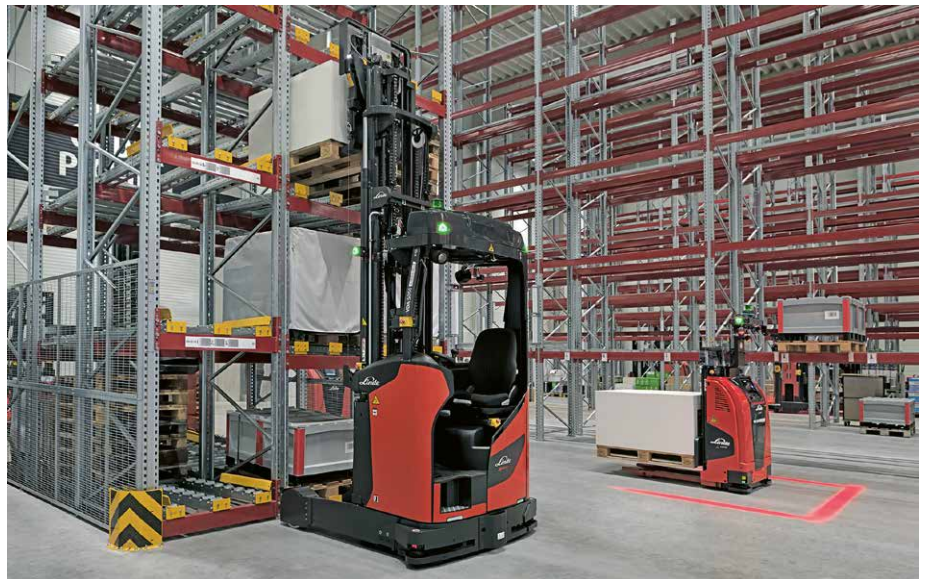
■ In Aschaffenburg zeigte Linde Material Handling sein Produktportfolio. Hier im Einsatz die Modelle R-Matic (links) mit 1,6 t Tragfähigkeit und L-Matic core mit einer Tragfähigkeit von 1,2 t.
