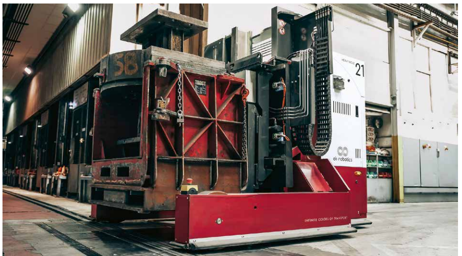
▣ Für Wechsel der bis zu 8 t schweren Formen ist eine Genauigkeit im Millimeterbereich gefragt
