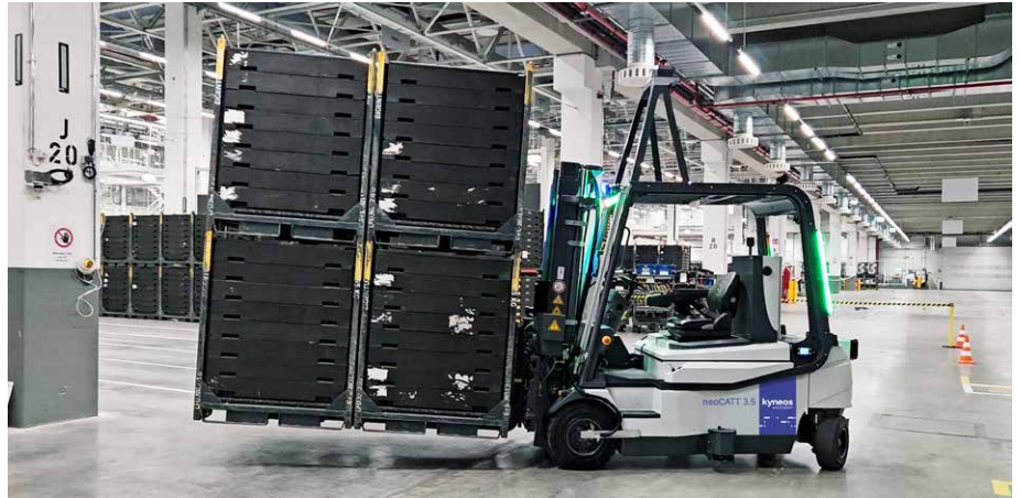
■ Der autonome Frontstapler neoCATT 3.5 im Einsatz: präzises Handling und sichere Navigation im Produktionsumfeld
