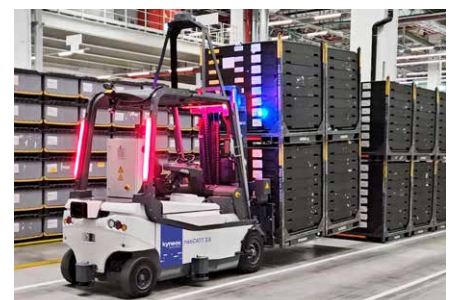
■ Zentimetergenaue Positionierung dank Lidar- und Kamertechnik – der neoCATT 3.5 stapelt sicher und effizient im Blocklager
