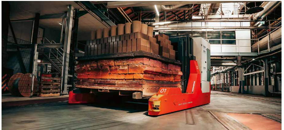
▣ Die aus einem Pulvergemisch gepressten Produkte werden zur Weiterverarbeitung transportiert. Das Gesamtgewicht – über 26 t
