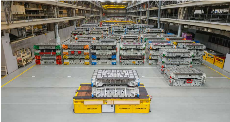
■ Der Schwerlast-Plattformwagen transportiert Presswerkzeuge mit einem Gewicht von bis zu 60 t
