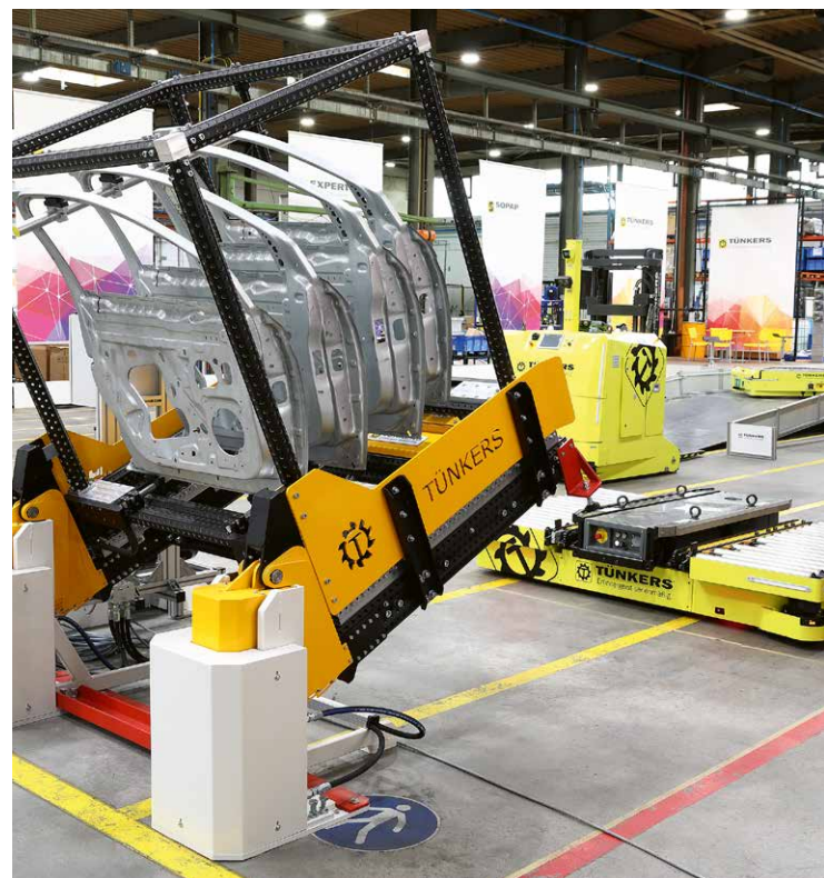
▣ Das Rollenbahn-FTF verfügt über ein aktives Kettengreifsystem, welches eine vollautomatische Aufnahme von Großladungsträgern ermöglicht
