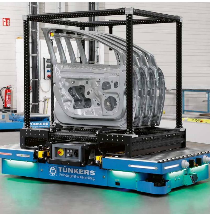
▣ Der TRoll wurde für den Transport von Großladungsträgern entwickelt
