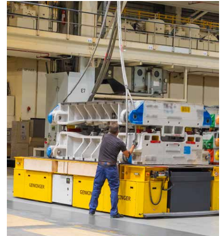
■ Die Werkzeuge werden per Deckenkran auf den Plattformwagen verladen
