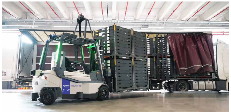
■ Vollautomatisierte LKW-Entladung: Der neoCATT 3.5 entnimmt just-in-sequence angelieferte Ladungsträger direkt aus dem Auflieger
