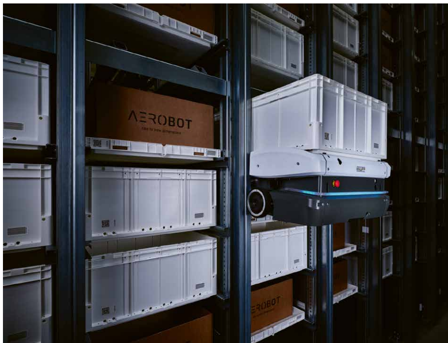
Die Open Shuttles lassen sich nahtlos an das Lagerrobotik-System AeroBot anbinden. Auch dieses besteht aus mobilen Robotern, die sich längs, quer am Boden und vertikal entlang der Regale bewegen.
