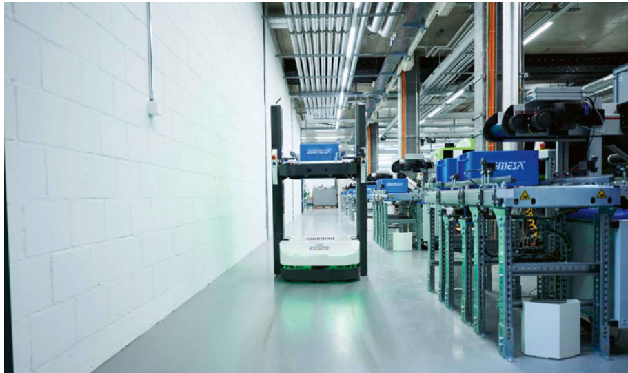
Die Open Shuttles von KNAPP sind ideal für den Einsatz in der Kunststoffindustrie geeignet. Beim Spritzgussproduzenten Digmesa sorgen sie für eine flexible Produktionsversorgung.
