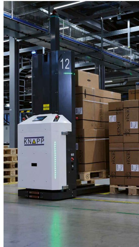
Die Open Shuttle Fork transportieren Paletten und Sonderladungsträger bis 1.300 kg. In der Kunststoffindustrie werden sie im Wareneingang und –ausgang eingesetzt.
