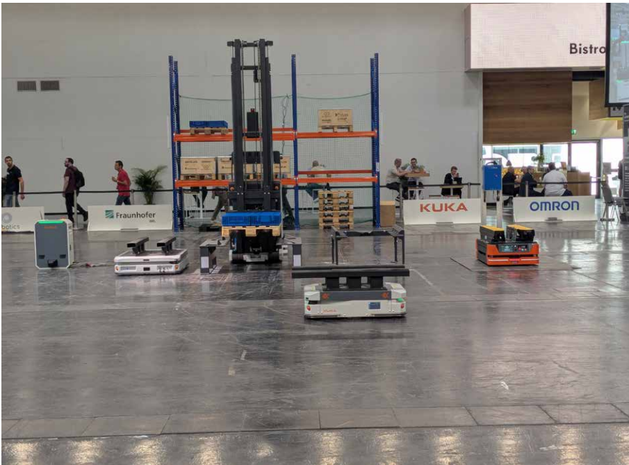
Teilnehmer im Mesh-Up waren MHP, ek robotics, Kuka, Safelog, dpm, Waitkus, Omron, INOS, Bosch Rexroth, Kärcher sowie Fraunhofer IML. Der Showcase zeigte zehn mobile Roboter orchestriert durch eine Leitsteuerung bei Nutzung der offenen Kommunikationsschnittstelle VDA 5050.
