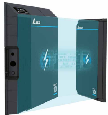
■ Eine direkte Datenübertragung erfolgt im Luftspalt zwischen den Ladepads mittels Magnetfelder im 13,56-MHz-Band.
