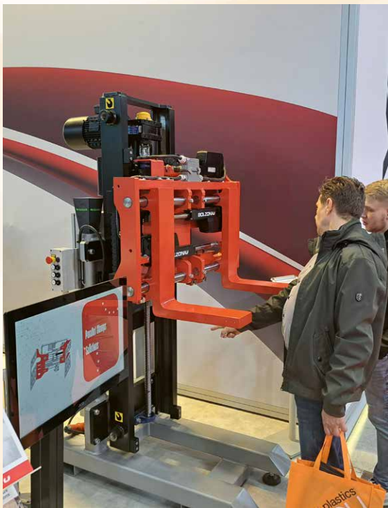
▲ LogiMAT bedeutet vor allem: „Hands on“ – wie hier auf dem Stand von Bolzoni, wo ein wellengeführter Seitenschieber begutachtet wird
