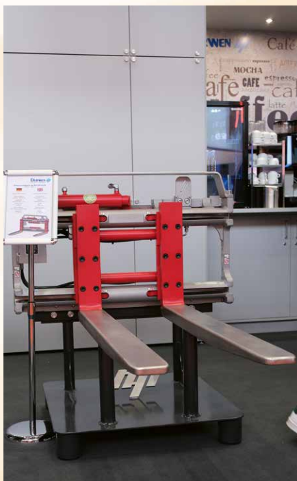
▲ Durwen aus Plaidt mit einem seiner leistungsstarken Zinkenversteller – hier ein Produkt aus der RZV-Serie, die für Stapler bis 8.000 kg Traglast angeboten werden
