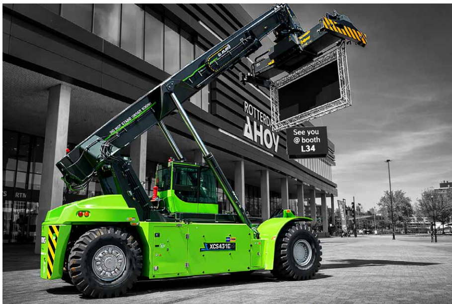
Der XCMG-Reachstacker XCS4531E wird mit LI-ION-Akkus von 300 bis 600 kWh geliefert
