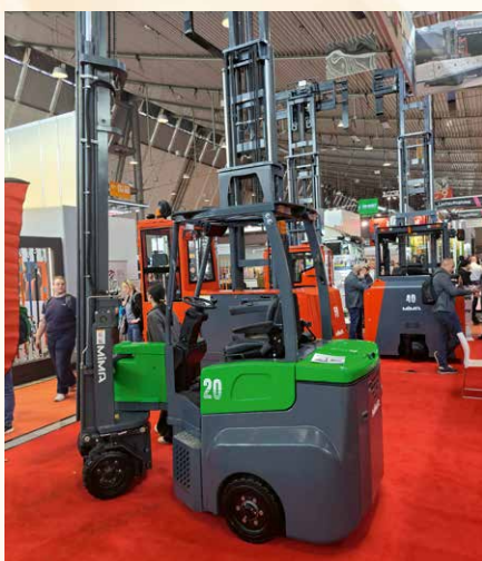
▀ Mima kann nicht nur Hochregalstapler – auch die eher in Großbritannien verbreiteten Knickstapler sind im Programm – sie gelten als Alternative zum Schubmaster. Im Hintergrund Mehrwegestapler
