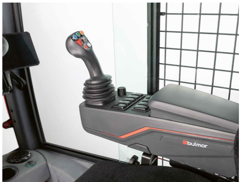
Kapazitiver Joystick und Armlehne mit Drehdrücksteller
