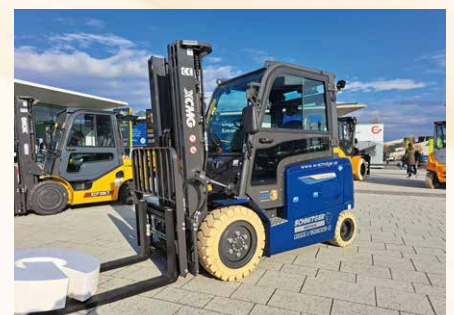
▀ XCMG war im Außen- und Innenbereich vertreten. Vermieter Schnitger aus Northeim hat 10 Geräte in der Mietflotte. Hier der 3,5-Tonner mit schmucker Vollkabine, nichtkreadender Bereifung, Triplexmast und LI-ION-Batterie
