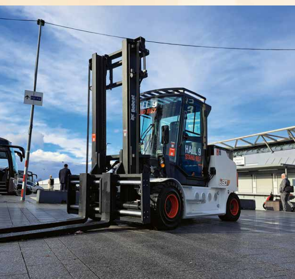
▣ Bobcat komplettiert das Programm nach oben mit Frontstaplern bis 25 t – hier der 8-Tonner. Klimatisierte Kabine, 8-Zoll-Display und Hubhöhen bis 7.225 mm machen klar: Bobcat wird mitreden
