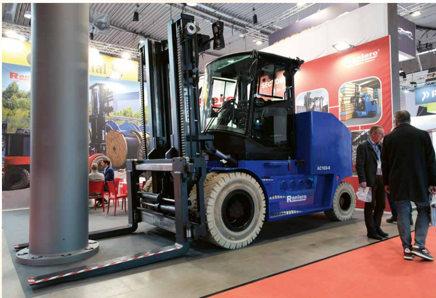
▲ Raniero, Kompaktstapler-Spezialist aus Fonte (Italien), trat mit dem neuen 16-Tonner AC160L mit 800 mm LSP auf. 120-V-Elektrik, 2.450 mm Gerätebreite und eine komfortable Kabine prädestinieren ihn etwa für den Einsatz in der Papier- und Getränkeindustrie
