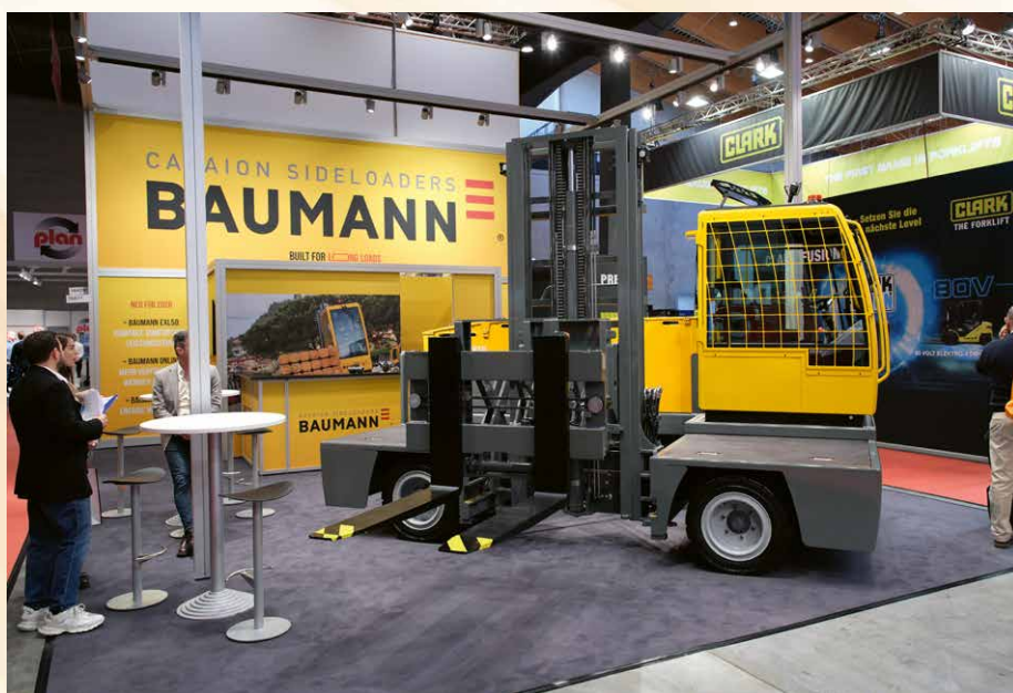
▲ Baumann aus Cavaion (Italien) mit einem SE-bereiften E-Seitenstapler – das Programm reicht auch bis Traglasten weit über 20 t
