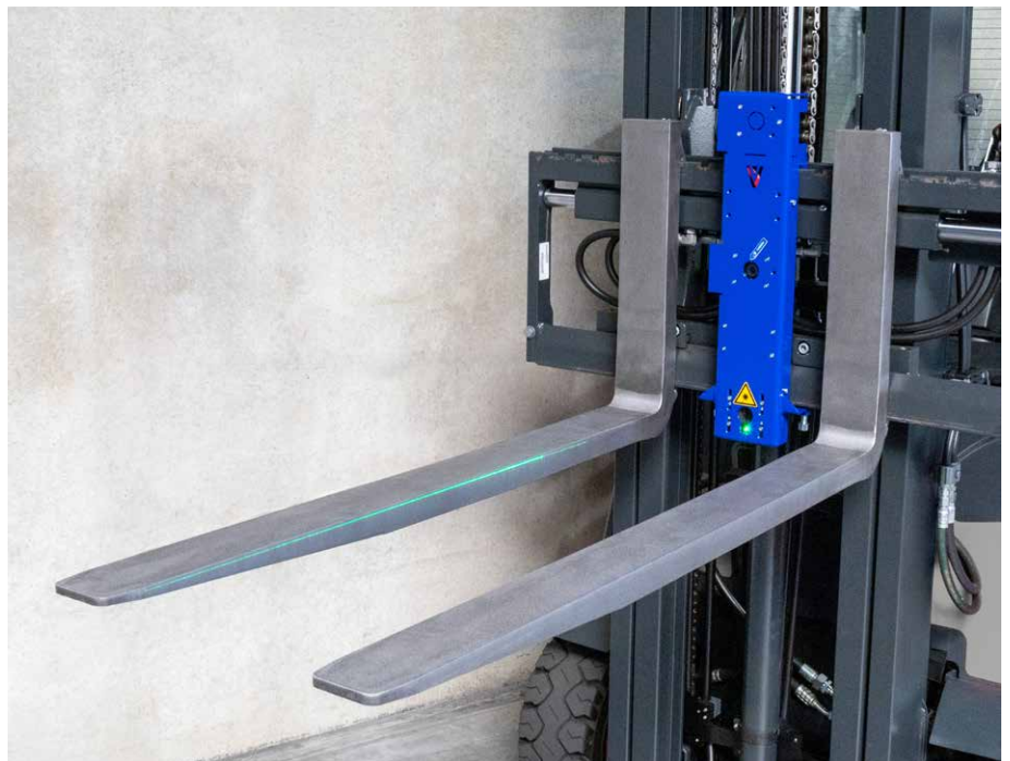
▣ Das Kamera- und Lasersystem Lizzard erleichtert das Positionieren der Gabelzinken
