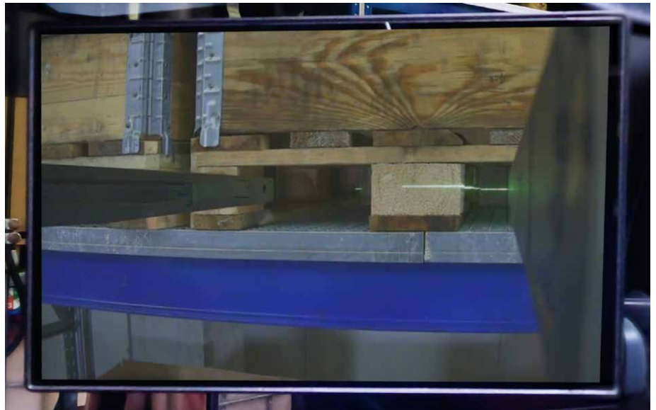
▣ Die Bilder der SmartFork SideCam ermöglichen freie Sicht auf die Gabelzinken
