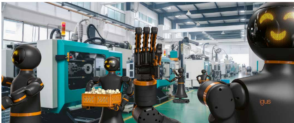
■ Im Kopf von Iggy Rob befindet sich das Display samt Gesichtszügen. LIDAR-Sensoren und 3D-Kameras im Brustbereich und im Fahrzeug dienen zur Objektdetektion
