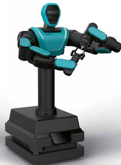
▣ System plexa mit zwei Roboterarmen und einem Fahrwerk
